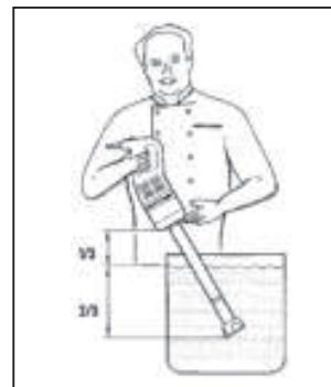
Можно также опереть аппарат на край кастрюли, слегка наклонив его и следя за тем, чтобы насадка не касалась дна рабочей емкости.
