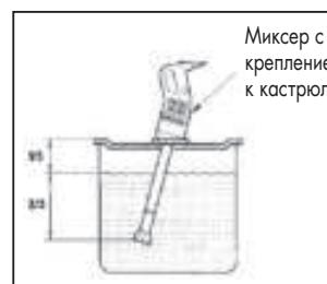
Во избежание разбрызгивания убедитесь, что насадка хорошо погружена в продукт, а вентиляционные отверстия блока двигателя не соприкасаются с жидкостью.
