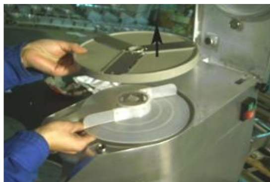
Установка режущей пластины (4)
