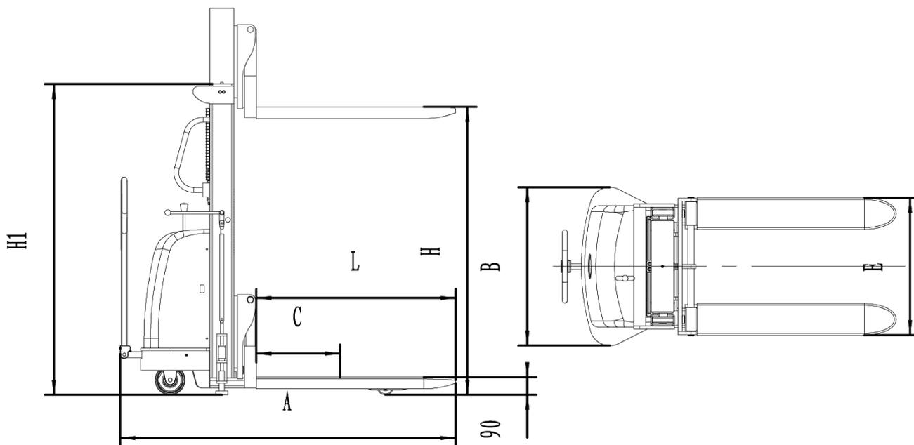
Рис.1 - Габаритные размеры штабелера гидравлического с электроподъемом DYC
