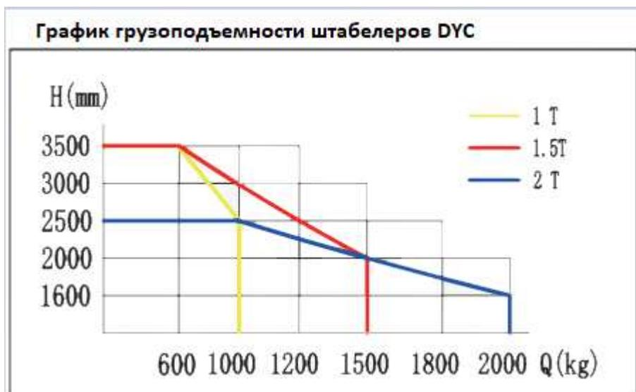
**Технические характеристики штабелера гидравлического с электроподъемом DYC с грузоподъемностью 1000 кг**
