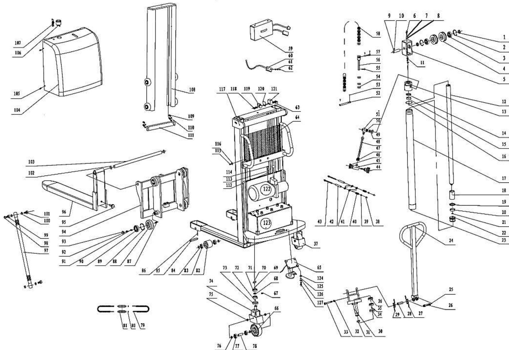
Рис. 2 - Взрыв схема штабелера с электроподъемом DYC
