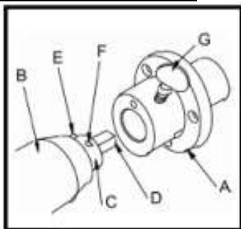
Перед установкой проверьте, что дежа не заполнена каким-либо продуктом (одновременное использование миксера для перемешивания и эксплуатация насадки запрещена). Отверните болт (G), удалите заглушку. Вставьте выбранную Вами собранную насадку (B) в отверстие вала отбора мощности (A), так чтобы штырь (D) на насадке попал в ответное отверстие на приливе корпуса миксера с одновременным совмещением квадратного хвостовика с соответствующим отверстием приводного вала.
