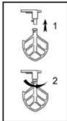
Установка может производится исключительно, если дежа опущена в крайнее нижнее положение. Поместите насадку в дежу, поднимите насадку вверх до упора так, чтобы вал привода попал в отверстие насадки, после этого поверните насадку по часовой стрелке. Удаление насадки производится в обратном порядке.
